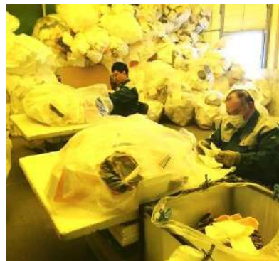
スーパーマーケットなどにある食品トレイの袋を回収し、プラスチックトレイなど違う物を取り除いて専用の機械に入れます。
